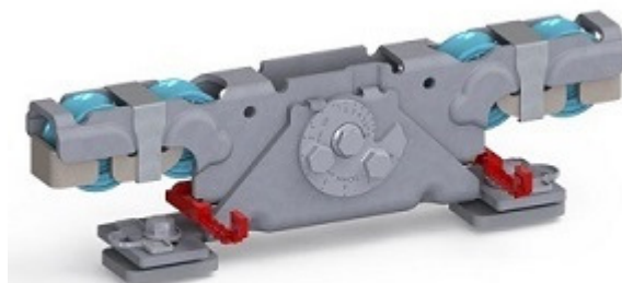
Doppelaufrollentechnologie samt Entgleisungsschutz und Exzenterschraube zur Höhenangleichung
