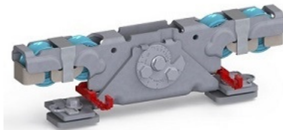
Doppelaufrollentechnologie samt Entgleisungsschutz und Exzenterschraube zur Höhenangleichung
