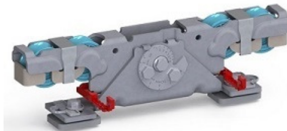
Doppelaufrollentechnologie samt Entgleisungsschutz und Exzentrerschraube zur Höhenangleichung
