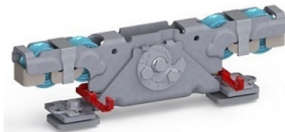
Doppelaufrollentechnologie samt Entgleisungsschutz und Exzentrerschraube zur Höhenangleichung
