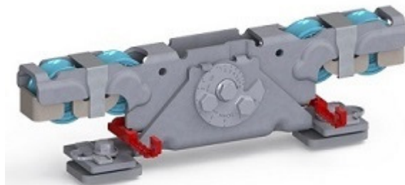
Doppelaufrollentechnologie samt Entgleisungsschutz und Exzenterschraube zur Höhenangleichung
