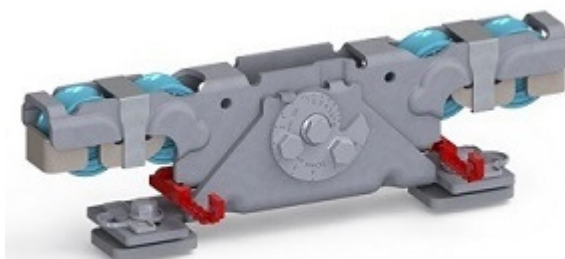
Doppelaufrollentechnologie samt Entgleisungsschutz und Exzentrerschraube zur Höhenangleichung
