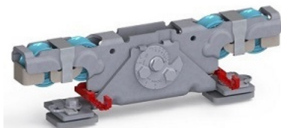
Doppelaufrollentechnologie samt Entgleisungsschutz und Exzenterschraube zur Höhenangleichung
