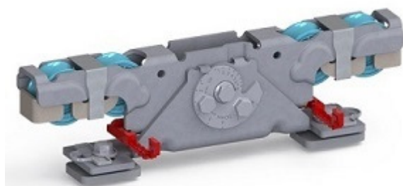
Doppelaufrollentechnologie samt Entgleisungsschutz und Exzenterschraube zur Höhenangleichung
