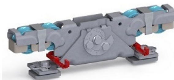
Doppelaufrollentechnologie samt Entgleisungsschutz und Exzenterschraube zur Höhenangleichung
