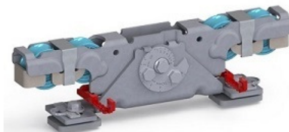
Doppelaufrollentechnologie samt Entgleisungsschutz und Exzenterschraube zur Höhenangleichung
