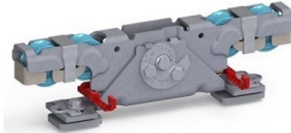
Doppelaufrollentechnologie samt Entgleisungsschutz und Exzenterschraube zur Höhenangleichung
