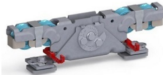
Doppelaufrollentechnologie samt Entgleisungsschutz und Exzenterschraube zur Höhenangleichung
