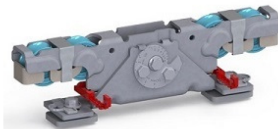
Doppelaufrollentechnologie samt Entgleisungsschutz und Exzenterschraube zur Höhenangleichung
