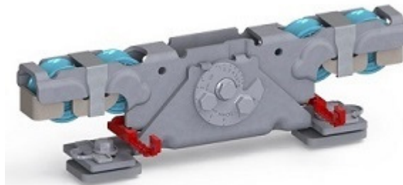
Doppelaufrollentechnologie samt Entgleisungsschutz und Exzenterschraube zur Höhenangleichung
