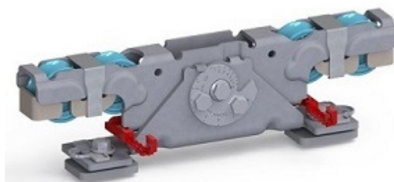
Doppelaufrollentechnologie samt Entgleisungsschutz und Exzenterschraube zur Höhenangleichung
