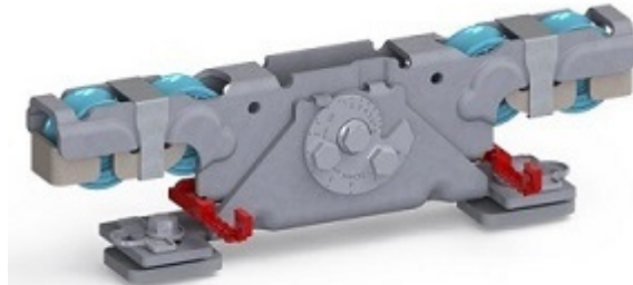
Doppelaufrollentechnologie samt Entgleisungsschutz und Exzenterschraube zur Höhenangleichung
