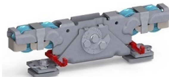
Doppelaufrollentechnologie samt Entgleisungsschutz und Exzenterschraube zur Höhenangleichung
