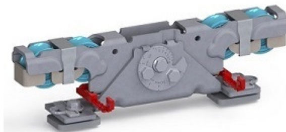
Doppelaufrollentechnologie samt Entgleisungsschutz und Exzentrerschraube zur Höhenangleichung
