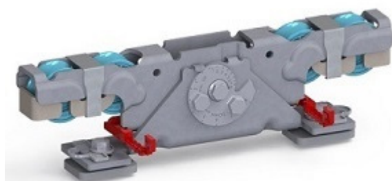
Doppelaufrollentechnologie samt Entgleisungsschutz und Exzenterschraube zur Höhenangleichung
