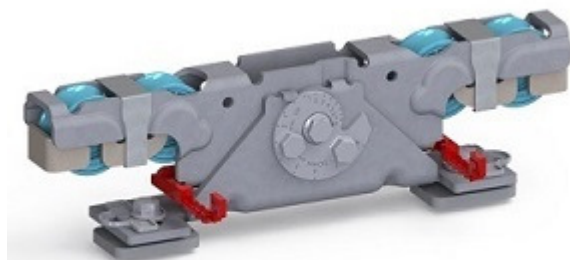
Doppelaufrollentechnologie samt Entgleisungsschutz und Exzenterschraube zur Höhenangleichung
