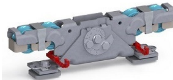
Doppelaufrollentechnologie samt Entgleisungsschutz und Exzenterschraube zur Höhenangleichung
