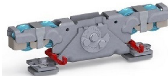
Doppelaufrollentechnologie samt Entgleisungsschutz und Exzenterschraube zur Höhenangleichung
