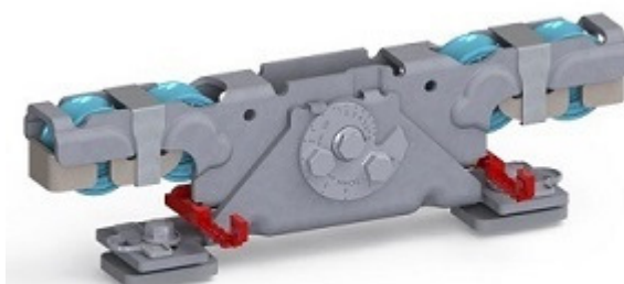
Doppelaufrollentechnologie samt Entgleisungsschutz und Exzentrerschraube zur Höhenangleichung
