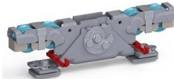
Doppelaufrollentechnologie samt Entgleisungsschutz und Exzenterschraube zur Höhenangleichung
