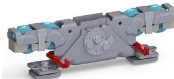
Doppelaufrollentechnologie samt Entgleisungsschutz und Exzentrerschraube zur Höhenangleichung
