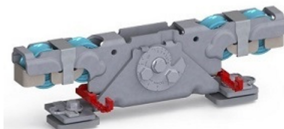
Doppelaufrollentechnologie samt Entgleisungsschutz und Exzentrerschraube zur Höhenangleichung
