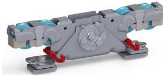
Doppelaufrollentechnologie samt Entgleisungsschutz und Exzenterschraube zur Höhenangleichung
