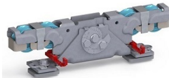
Doppelaufrollentechnologie samt Entgleisungsschutz und Exzentrerschraube zur Höhenangleichung
