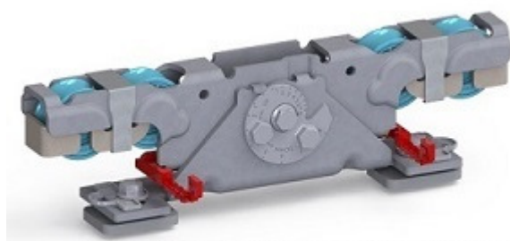
Doppelaufrollentechnologie samt Entgleisungsschutz und Exzenterschraube zur Höhenangleichung
