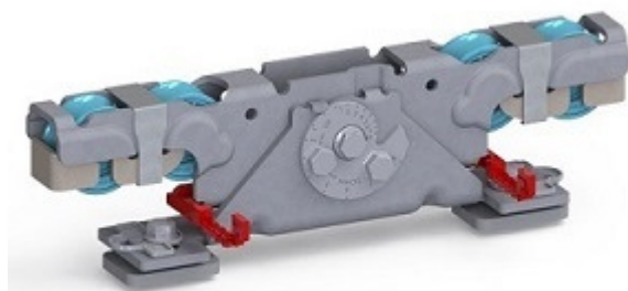
Doppelaufrollentechnologie samt Entgleisungsschutz und Exzenterschraube zur Höhenangleichung
