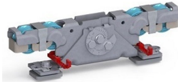
Doppelaufrollentechnologie samt Entgleisungsschutz und Exzenterschraube zur Höhenangleichung
