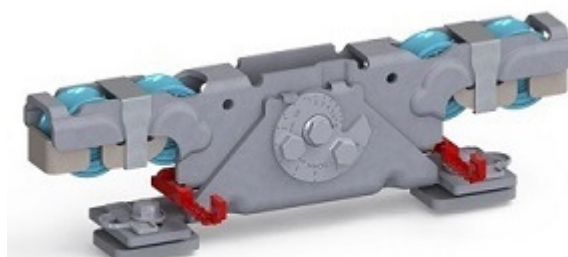
Doppelaufrollentechnologie samt Entgleisungsschutz und Exzentrerschraube zur Höhenangleichung
