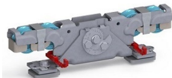
Doppelaufrollentechnologie samt Entgleisungsschutz und Exzentrerschraube zur Höhenangleichung
