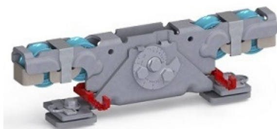
Doppelaufrollentechnologie samt Entgleisungsschutz und Exzenterschraube zur Höhenangleichung
