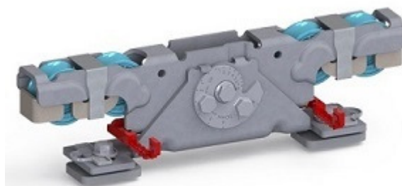
Doppelaufrollentechnologie samt Entgleisungsschutz und Exzenterschraube zur Höhenangleichung
