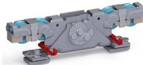
Doppelaufrollentechnologie samt Entgleisungsschutz und Exzenterschraube zur Höhenangleichung
