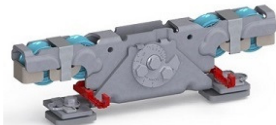
Doppelaufrollentechnologie samt Entgleisungsschutz und Exzenterschraube zur Höhenangleichung
