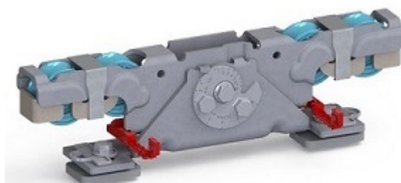
Doppelaufrollentechnologie samt Entgleisungsschutz und Exzenterschraube zur Höhenangleichung
