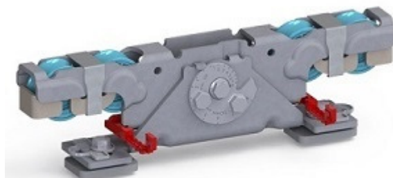
Doppelaufrollentechnologie samt Entgleisungsschutz und Exzentrerschraube zur Höhenangleichung
