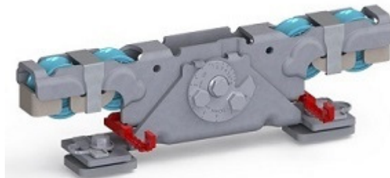
Doppelaufrollentechnologie samt Entgleisungsschutz und Exzenterschraube zur Höhenangleichung
