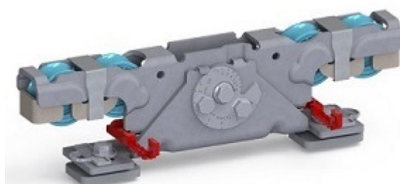
Doppelaufrollentechnologie samt Entgleisungsschutz und Exzentrerschraube zur Höhenangleichung
