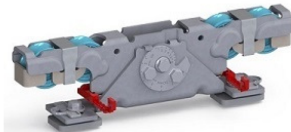
Doppelaufrollentechnologie samt Entgleisungsschutz und Exzentrerschraube zur Höhenangleichung
